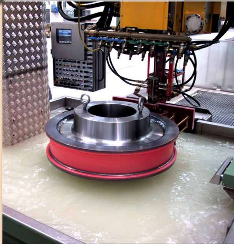
Ruedas Puente Grúa
